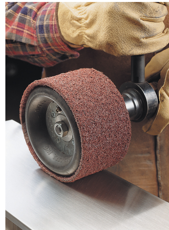
Nadawanie szlif dekoracyjnego włókniną SC A MED
